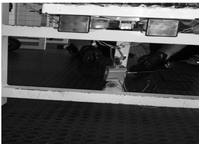
Fig.2. Célula de carga presa ao mosquetão e corrente.
