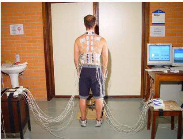
Aquisição de EMGs com 16 canais na UFRGS
